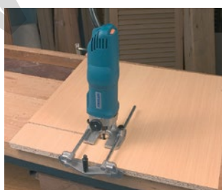
Fresado de regatas paralelas con guía lateral.
