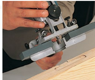
Colocación de pernios con el cabezal ZB93.
