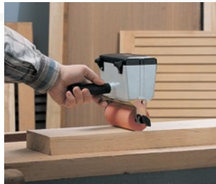
Encolado con colas vinílicas (blancas).
