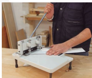
Corte de gran perfección. Con pisor automático.
