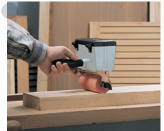
Encolado con colas vinílicas (blancas).
