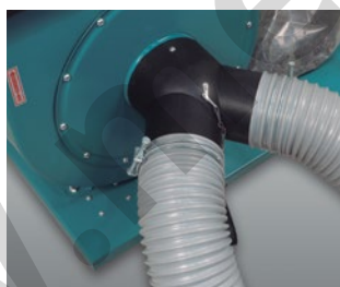
Con dos tomas de aspiración, incluye de origen 2 tubos de Ø 100 mm.
