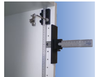
Taladrado para la colocación de bisagras invisibles.
