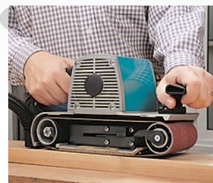
Lijado uniforme y sin surcos.
