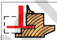
Ranurado de ventana por lado vierte aguas.
