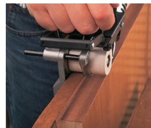
Aplacado de la cara superior del solape.
