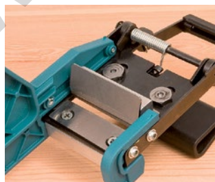
Sistema de corte con dos cuchillas.
