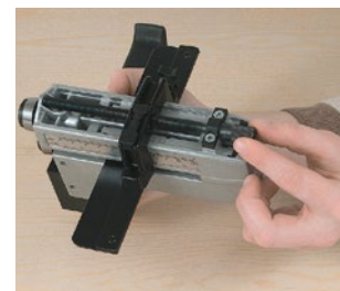
Ajuste micrométrico de la anchura de corte.
