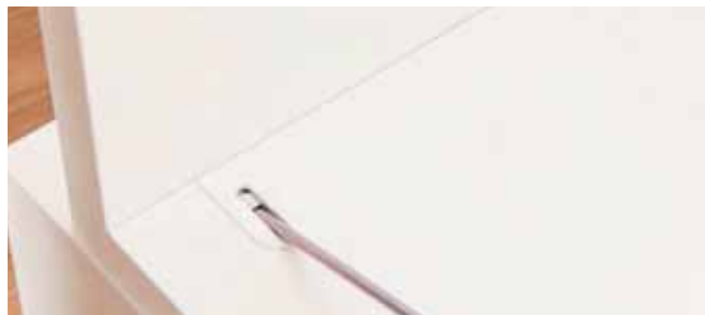
Unir los elementos del mueble con atornillador a batería y una herramienta Cabineo. El trabajo es fácil y rápido gracias a un par de apriete predefinido de aprox. 2.5 Nm.
