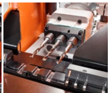
Taladrado horizontal (solo posible con MINIPRESS top)
