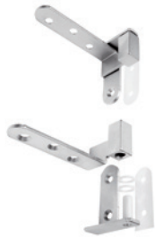
Bisagras pivotantes. Soportan hasta 65 Kg. Permiten mínima regulación vertical mediante arandelas.
