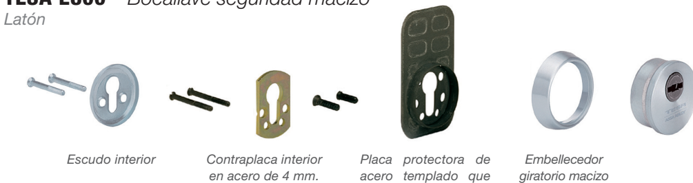
Núcleo escudo: totalmente de acero macizo reforzado, que robustece sobremedida el escudo. A su vez se han hecho unas incrustaciones de bolas también de acero, que si se pretendiera taladrarlo, impedirían el avance de las brocas.
