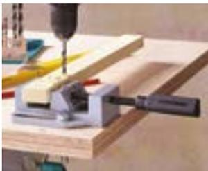
Mordaza de sujeción con ranuras en V horizontales y verticales para sujetar material redondo.
