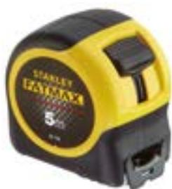
Hoja extra ancha. Revestimiento termoplástico en los 8 primeros centímetros de la hoja. Gancho con 3 remaches y amortiguador del retroceso para evitar rotura. Caja bimateria antideslizante revestida con elastómero. Clip de sujeción al cinturón. Aguanta sin doblarse 3,3 m.
