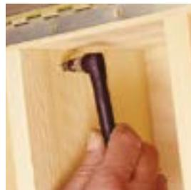
Permite taladrar y atornillar en un ángulo de 90° en espacios muy estrechos. Medida entre vértices de tan solo 52 mm. (inclusive punta de 25 mm.) El engranaje con rodamiento de bolas permite un sencillo giro hacia la derecha / izquierda al atornillar y desatornillar.
