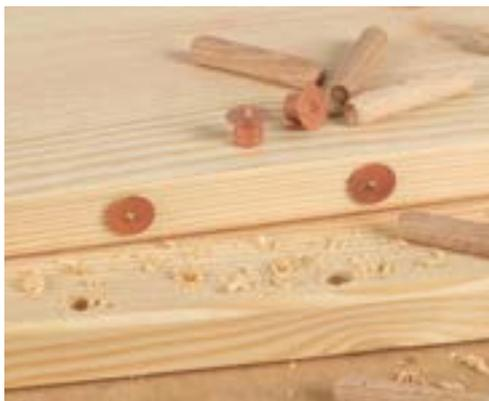
Una solución asequible para marcar las posiciones de perforación contrarias de uniones de madera. Fabricación robusta y duradera de acero. Dispone de un eje para insertar en los agujeros perforados para espigas de la primera parte de la pieza de trabajo, mientras que el otro lado cuenta con un mandril metálico que sobresale para marcar las posiciones correctas de perforación en la pieza de trabajo complementaria.
