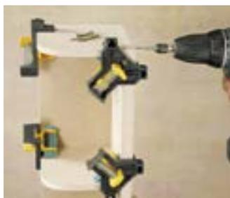
Dispositivo de fijación para atornillar o encolar tablas.
