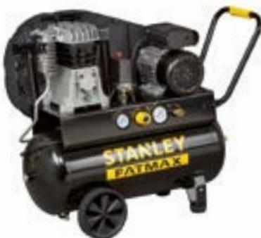
Cabezal compresor de elevada fiabilidad, con cilindro de fundición. Amplia superficie de ventilación para una mejor refrigeración. Cáster sobre dimensionado que garantiza una excelente lubricación. Robustas ruedas sobre dimensionadas que garantizan una elevada estabilidad y una mayor facilidad en el transporte. Grifo de purga de esfera, profesional, con paso aumentado para evitar obstrucciones y bloqueo. Monofásico.
