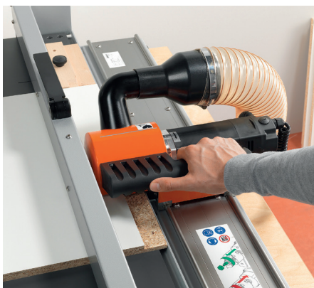
Fresado del fondo de 15-16 mm tope de madera.
