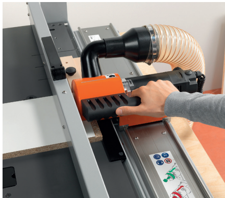
Fresado de trasera >16-19 mm. para TANDEMBOX y LEGRABOX con tope de madera incluidos.
