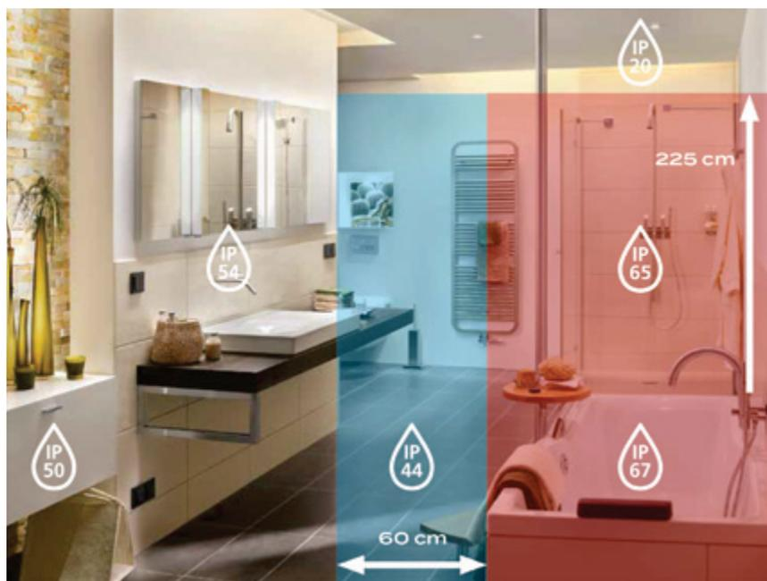
El siguiente esquema nos muestra qué valores de IP deberían cumplir los productos de iluminación, según su posición en un baño.
